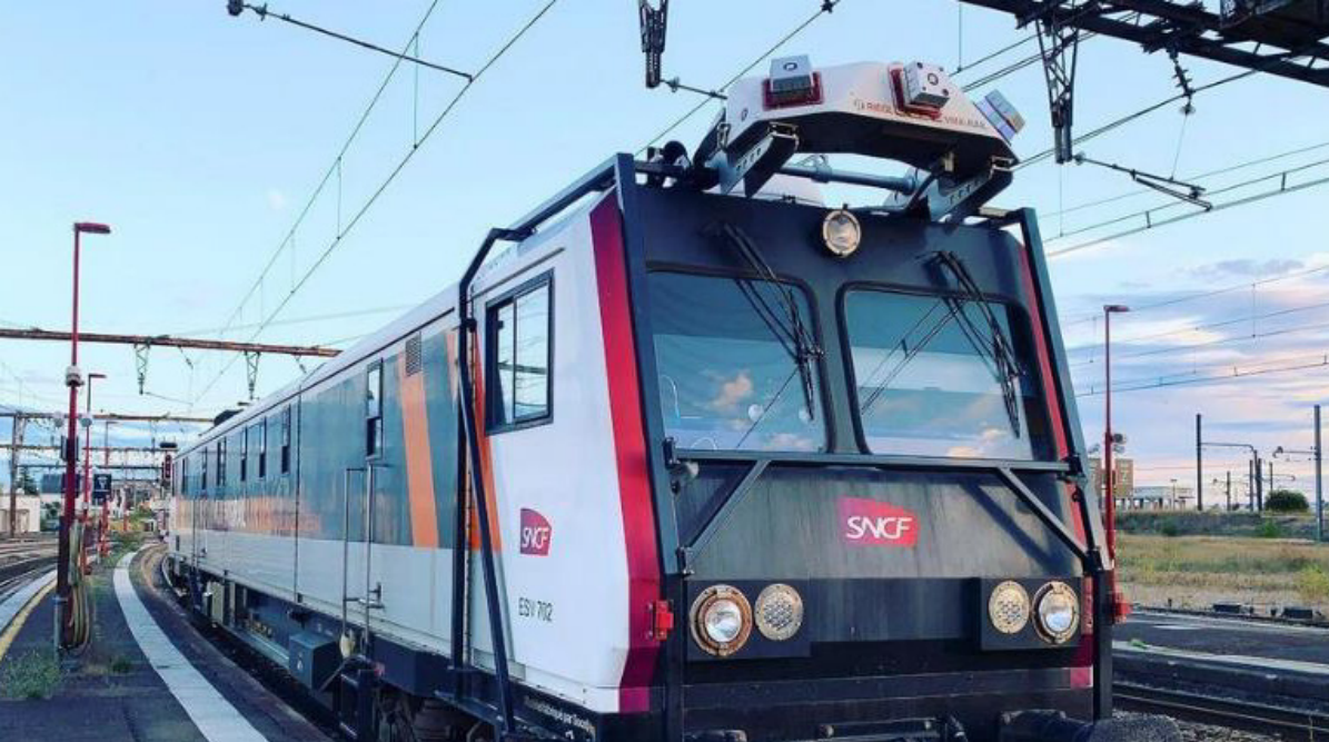
ESV 702 équipé du système d'acquisition LiDAR VMX Rail
